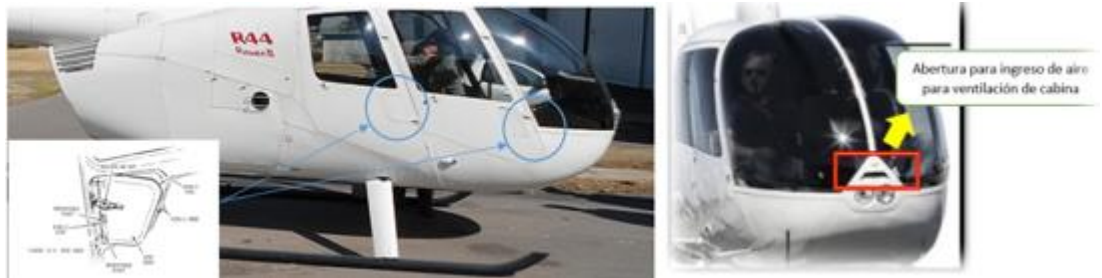
Fotografías N°23 y 24: Ubicación de las compuertas de ventilación en el helicóptero R44 II.
