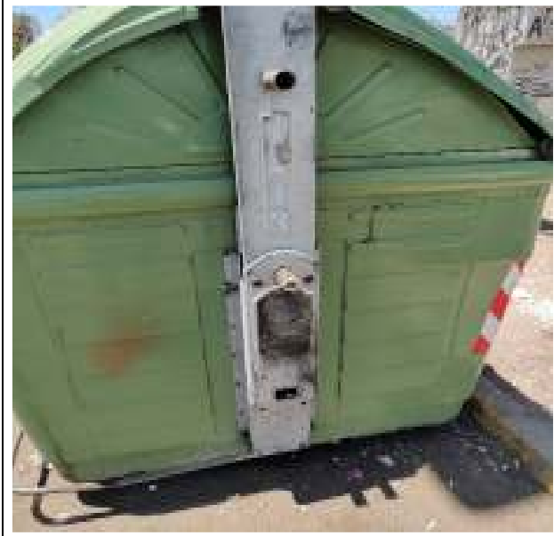
Fotografía N° 4: Contenedor N° 1213 con pedal de levante malo, cuadrante E.
