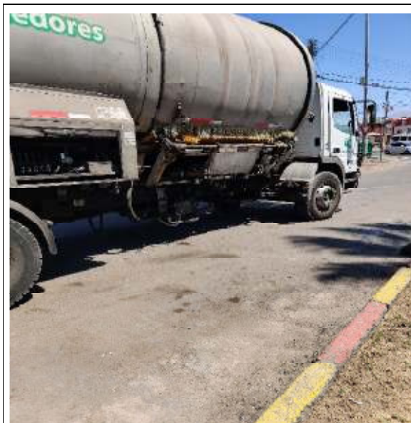
Fotografía N° 5: Sistema de levante automatizado de camión lava contenedores, cuadrante D
